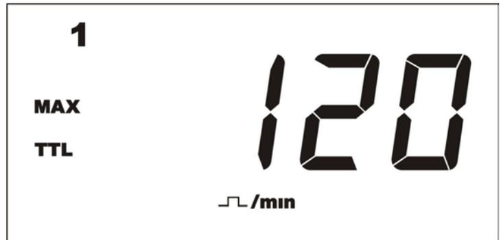
Introducido el valor de la máxima frecuencia, ahora debemos introducir el valor mínimo de la frecuencia en correspondencia a la activación del SETPOINT.
