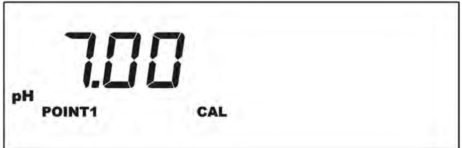
Una vez entrando en la función de calibración, en la pantalla aparecerá el mensaje CAL.1, cuando esto suceda apretar las teclas
