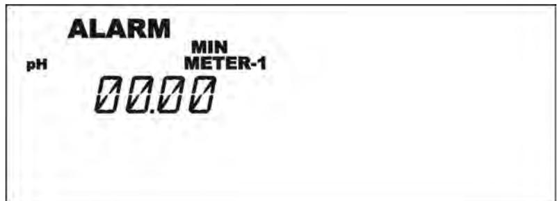
Alarma OVER, el instrumento puede ir en alarma, cuando la medición no forme parte del valor de setpoint en los tiempos previstos, para activar tal función será necesario proseguir de la siguiente manera:
