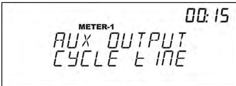
En vez, en el caso de la función **Flocculant** será posible implementar las horas y los minutos de activación de la salida auxiliar, el mensaje que aparecerá en la pantalla será el siguiente:
