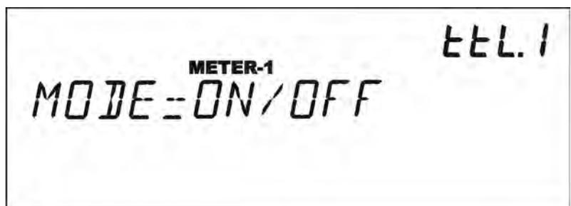
mínimo implementado, en vez, en la modalidad ON-OFF, la salida TTL será activada cuando cambiará posición su correspondiente relé de SETPOINT,
